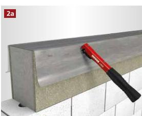
Die Folie auf der ungedämmten Schalung mit Hammertacker und Feindrahtklammern befestigen. Klammen nach Aushärten vollständig entfernen.
