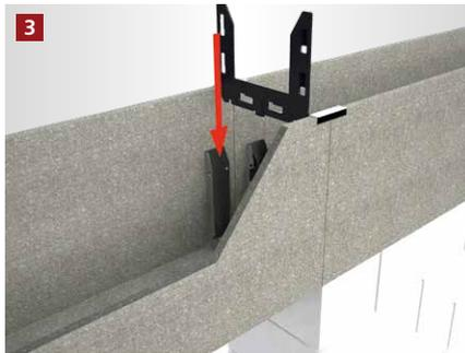
Der Bewehrungskorbpositionierer wird in die MBA® Schalung eingesetzt.
