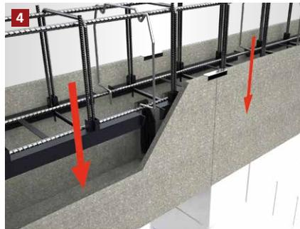
Der Bewehrungskorb wird in die Ringbalken- und Sturzschalung eingelassen. Bei Verwendung des Bewehrungskorbpositionierers ist eine ausreichende Betondeckung gewährleistet.
