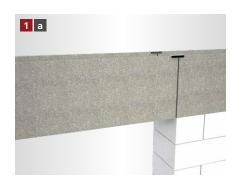
MBA® Sturzschalung / U-Schalung an der Ringbalkenschalung ausrichten und nur über Mauerwerksöffnungen (ohne Auflage) verwenden.
