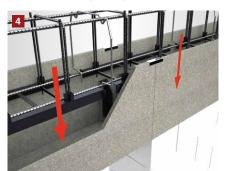
Der Bewehrungskorb wird in die Ringbalken- und Sturzschalung eingelassen. Bei Verwendung des Bewehrungskorbpositionierers ist eine ausreichende Betondeckung gewährleistet.
