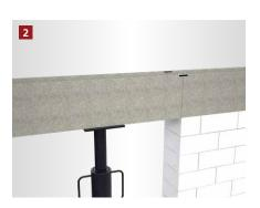
Die Schalung wird mit der entsprechenden Anzahl an Stützen abgestützt.
