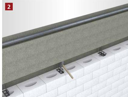
Bei Vollsteinen kann die Schalung zusätzlich genagelt / angeschossen werden.
