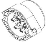
**Primärdichtung Telekommunikation** zur innenseitigen Aufnahme der Telekommunikationsleitungen
