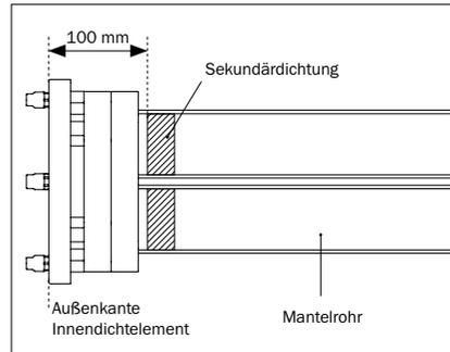
Abbildung 12.3: Sekundärdichtung Strom/Wasser - Abstand zum Innendichtelement
