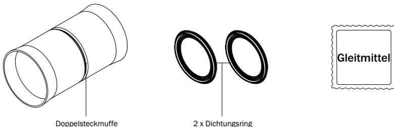
Abbildung 7.1: KRASO® BKP - Wand - Verlängerungsset zur außenseitigen Verlängerung des vormontierten Mantelrohrs mit bauseitig gestelltem Kabelschutz-/Wellrohr DN 75
