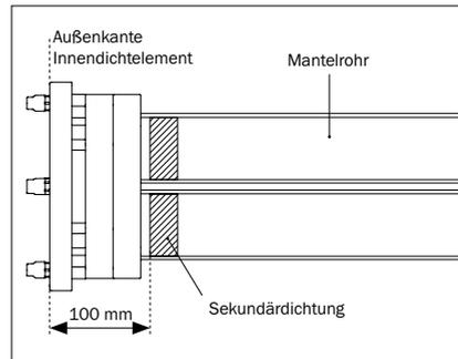
Abbildung 13.3: Sekundärdichtung Strom/Wasser - Abstand zum Innendichtelement
