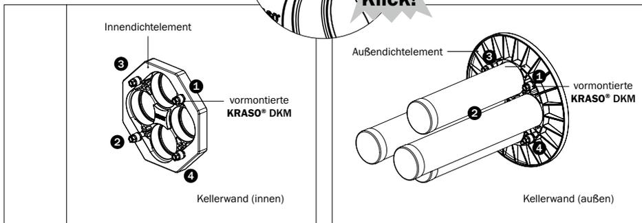
Abbildung 5.7: KRASO® DKM – Anziehen beim Innendichtelement
