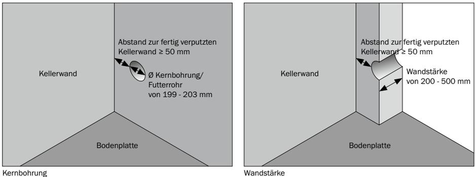
Abbildung 4.1: Abmessungen
