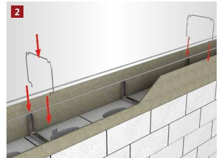
Die unteren Stabstähle werden in die Bewehrung gelegt und mit dem Steckbügel fixiert.
