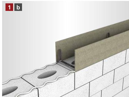
Die MBA® Ringbalkenschalung wird mit den U-Abstandshaltern nach unten auf dem Mauerwerk aufgestellt und ausgerichtet. Bei Vollsteinen kann die Schalung ebenfalls genagelt / angeschossen werden.
