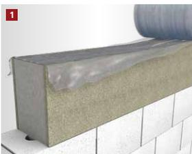
Die Schalung nach dem Betonieren mit der Folie abdecken.
