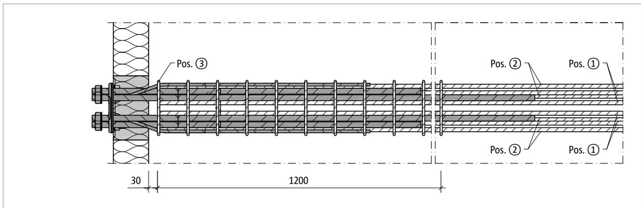
Abb. 57: Schöck Isokorb® XT Typ SK-MM2: Bauseitige Bewehrung, Grundriss
