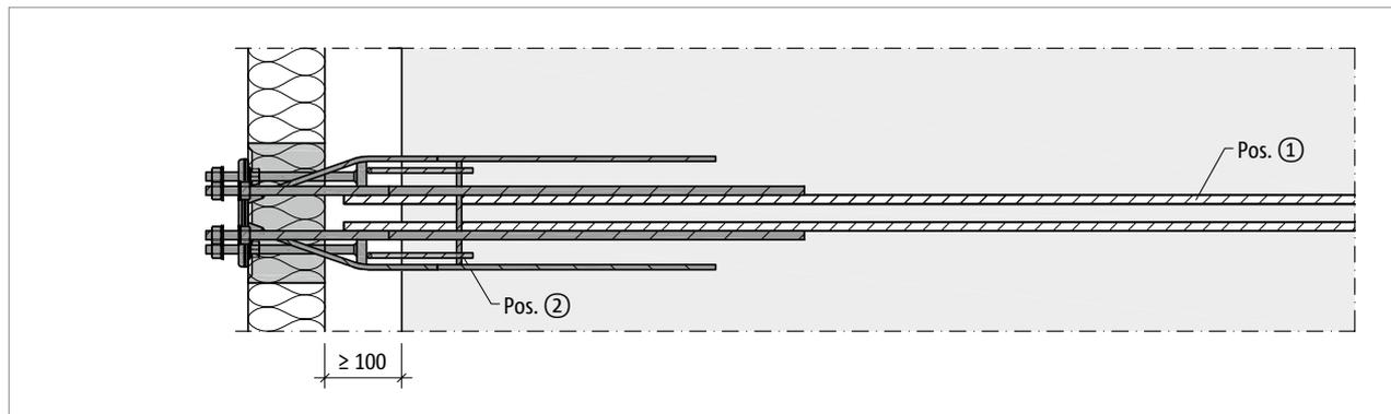
Abb. 59: Schöck Isokorb® XT Typ SK-M1: Bauseitige Bewehrung bei Halfertigteilbauweise, Grundriss
