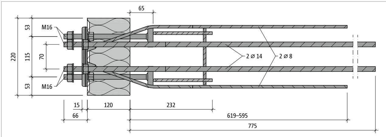
Abb. 44: Schöck Isokorb® XT Typ SK-M1-V1: Grundriss
