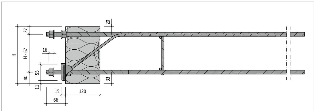
Abb. 48: Schöck Isokorb® XT Typ SK-MM1-VV1: Produktschnitt
