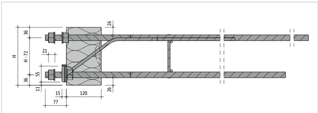
Abb. 49: Schöck Isokorb® XT Typ SK-MM2: Produktschnitt
