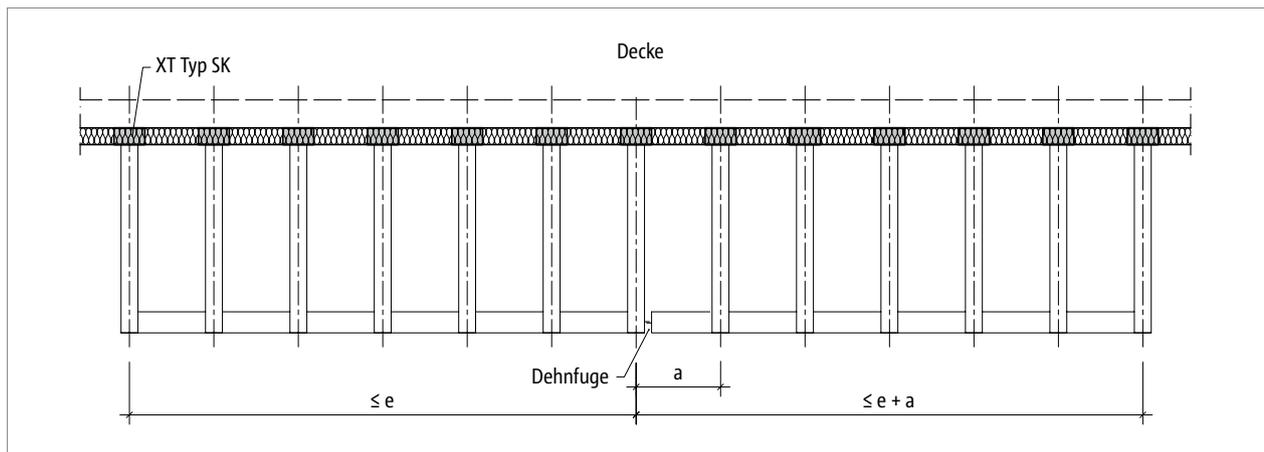
Abb. 37: Schöck Isokorb® XT Typ SK: Maximaler Dehnfugenabstand  $e$
