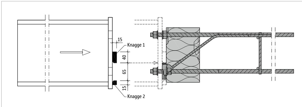
Abb. 72: Schöck Isokorb® XT Typ SK: Montage des Stahlträgers
