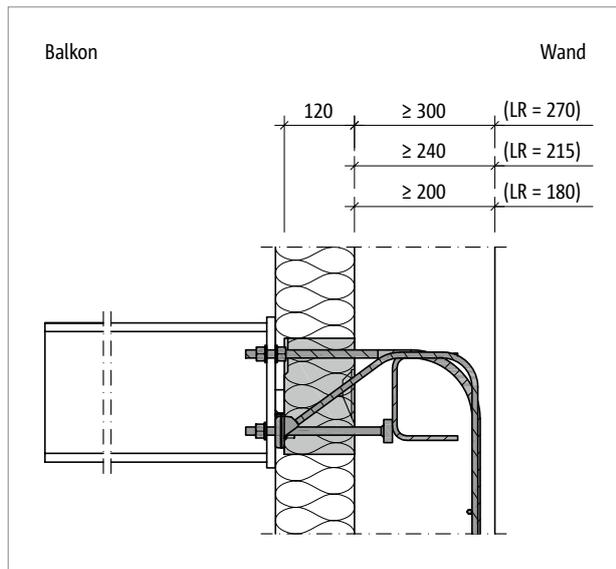
Abb. 32: Schöck Isokorb® XT Typ SK-WU: Sonderkonstruktion für Wandanschluss
