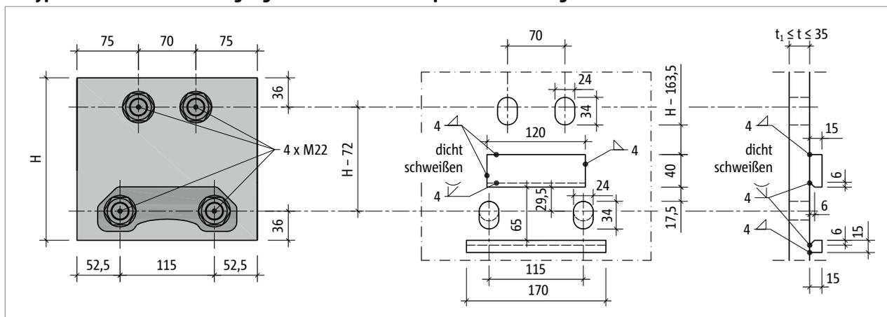
Abb. 68: Schöck Isokorb® XT Typ SK-MM2: Konstruktion des Stirnplattenanschlusses; Rundlöcher unten, alternativ Langlöcher und eine zweite Knagge zur Übertragung der negativen Querkraft
