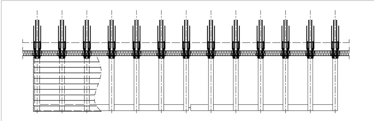
Abb. 25: Schöck Isokorb® XT Typ SK: Balkon frei ausragend
