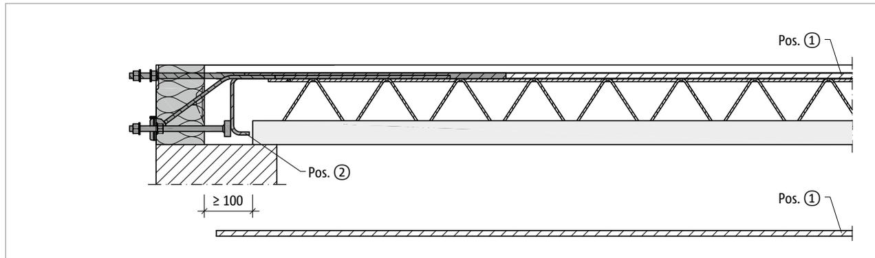
Abb. 58: Schöck Isokorb® XT Typ SK-M1: Bauseitige Bewehrung bei Halfertigteilbauweise, Schnitt
