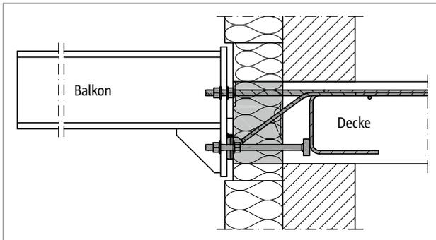
Abb. 28: Schöck Isokorb® XT Typ SK: Barrierefreier Übergang durch Höhenversatz
