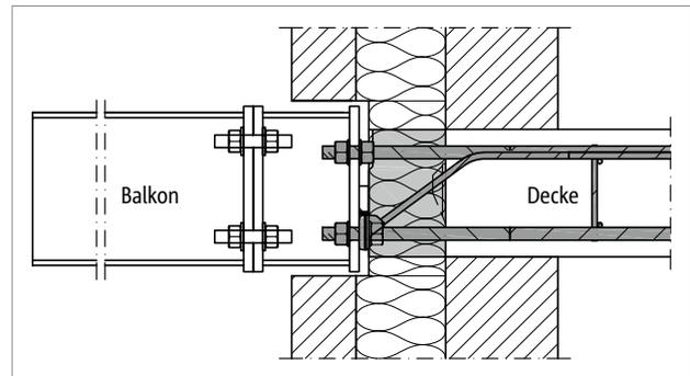
Abb. 27: Schöck Isokorb® XT Typ SK: Dämmkörper innerhalb der Kerndämmung; bauseitiges Verbindungsstück zwischen dem Isokorb® und dem Balkon schafft Flexibilität im Bauablauf
