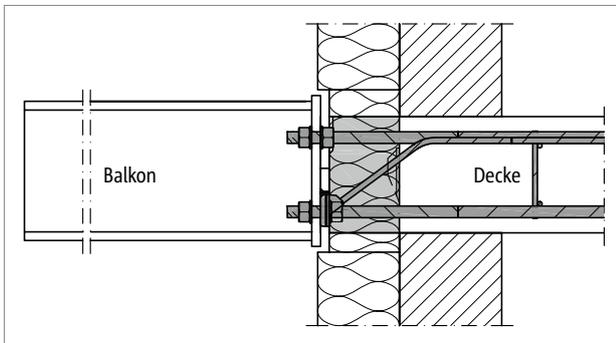
Abb. 26: Schöck Isokorb® XT Typ SK: Anschluss an die Stahlbetondecke; Dämmkörper innerhalb der Außendämmung
