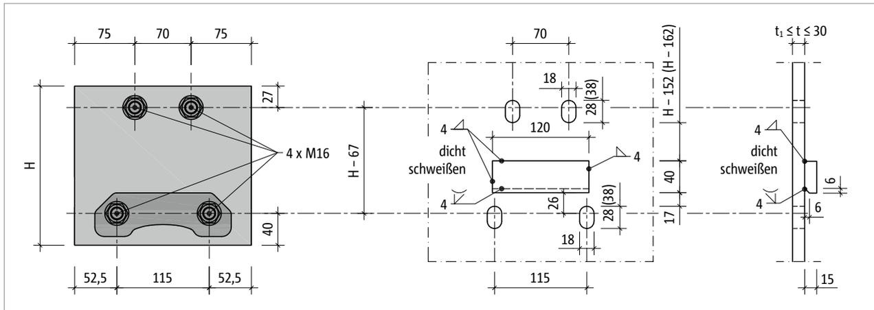
Abb. 65: Schöck Isokorb® XT Typ SK-M1: Konstruktion des Stirnplattenanschlusses
