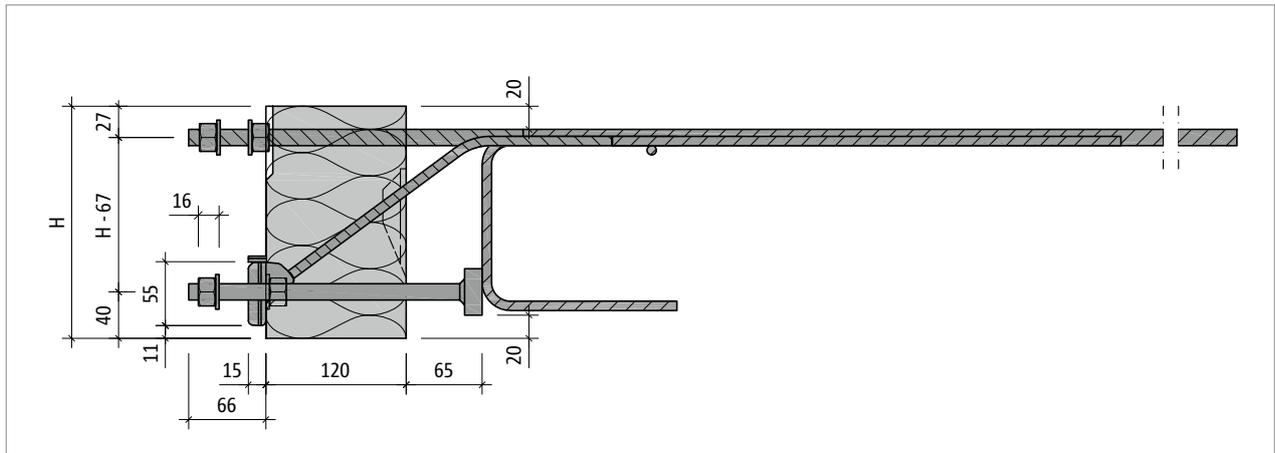
Abb. 47: Schöck Isokorb® XT Typ SK-M1: Produktschnitt
