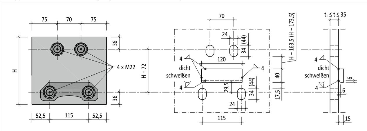
Abb. 67: Schöck Isokorb® XT Typ SK-MM2: Konstruktion des Stirnplattenanschlusses
