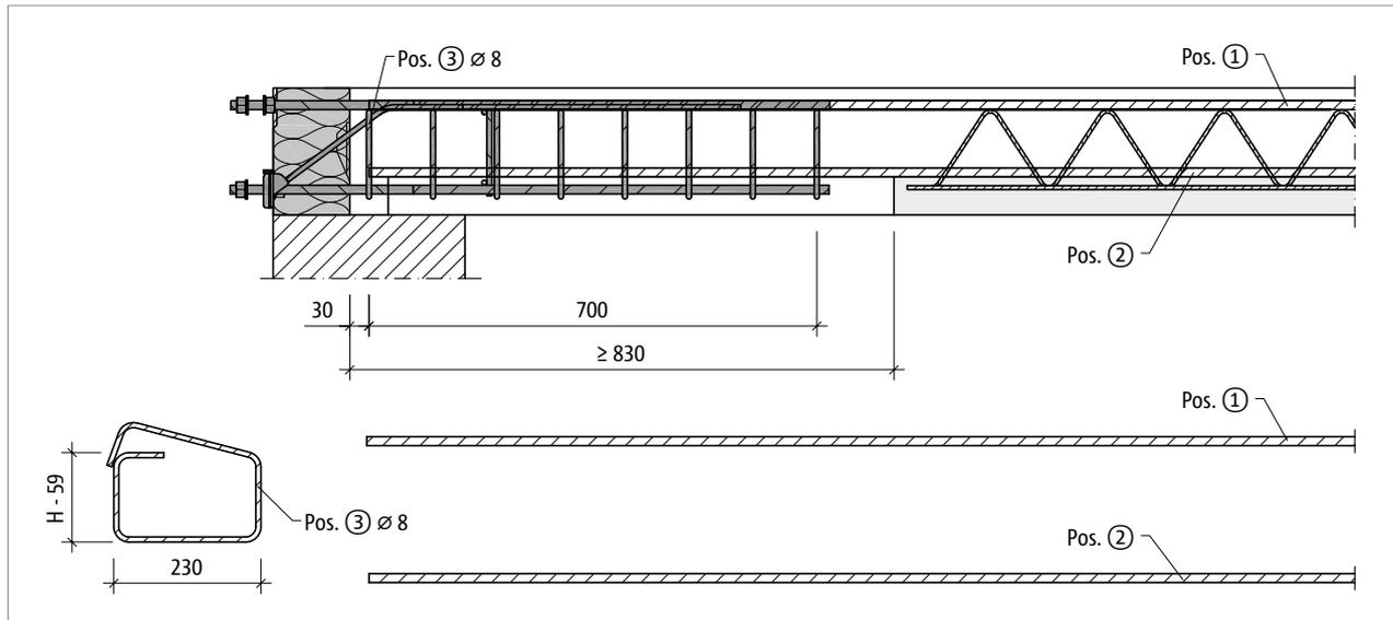
Abb. 60: Schöck Isokorb® XT Typ SK-MM1-VV1: Bauseitige Bewehrung bei Halbfertigteilbauweise, Schnitt
