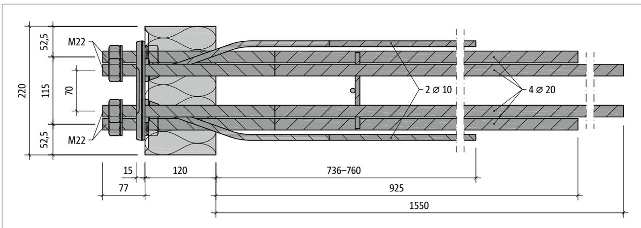
Abb. 46: Schöck Isokorb® XT Typ SK-MM2-VV1: Grundriss
