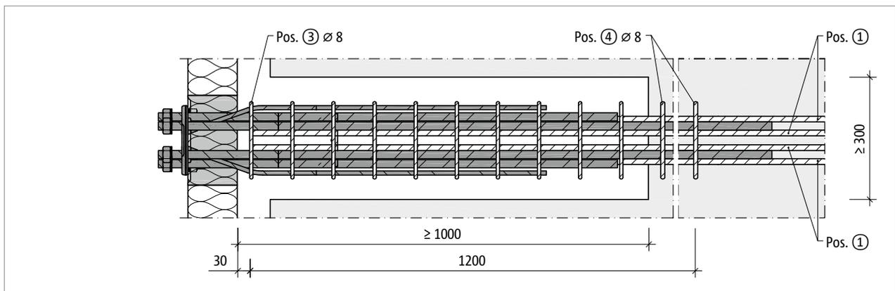
Abb. 64: Schöck Isokorb® XT Typ SK-MM2: Bauseitige Bewehrung bei Fertigteilbauweise, Grundriss
