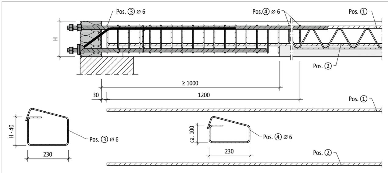
Abb. 62: Schöck Isokorb® XT Typ SK-MM2: Bauseitige Bewehrung bei Fertigteilbauweise mit Bügel  $\varnothing 6$  mm; Schnitt
