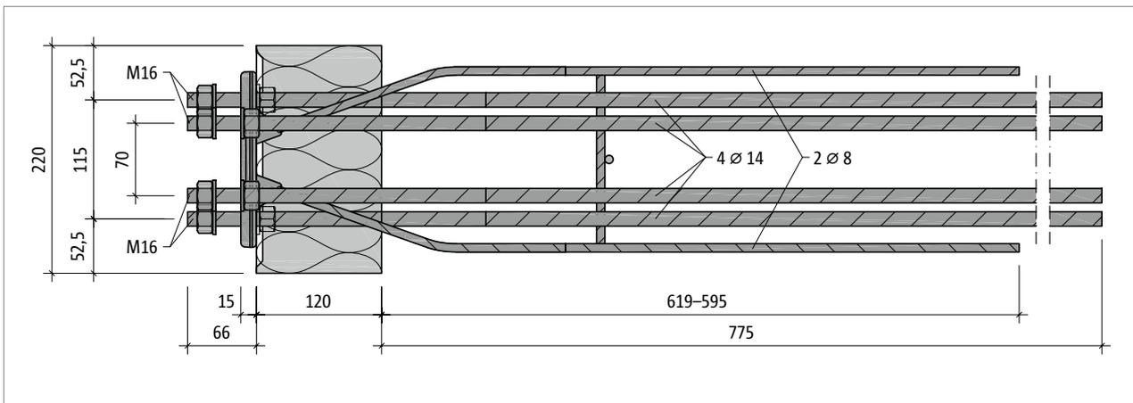
Abb. 45: Schöck Isokorb® XT Typ SK-MM1-VV1: Grundriss
