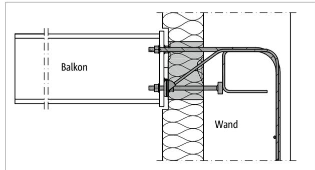
Abb. 29: Schöck Isokorb® XT Typ SK-WU-M1: Sonderkonstruktion für Wandanschluss auf Basis der Haupttragstufe M1 für Wandstärken ab 200 mm
