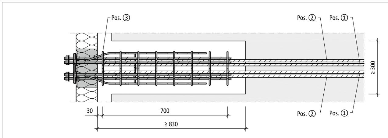
Abb. 61: Schöck Isokorb® XT Typ SK-MM1-VV1: Bauseitige Bewehrung bei Halbfertigteilbauweise, Grundriss
