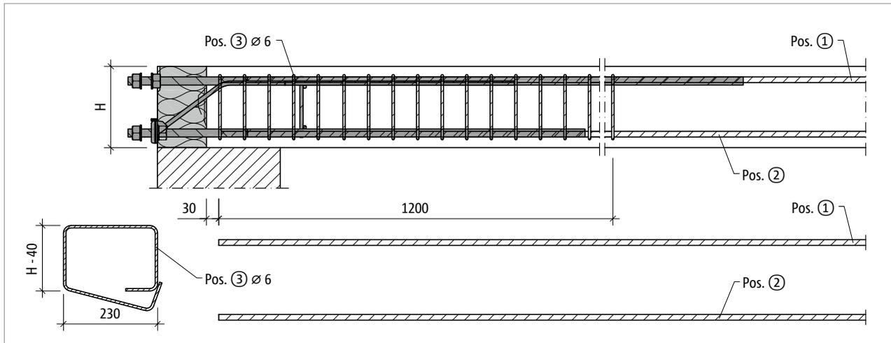
Abb. 55: Schöck Isokorb® XT Typ SK-MM2: Bauseitige Bewehrung mit Bügel  $\varnothing 6$  mm; Schnitt
