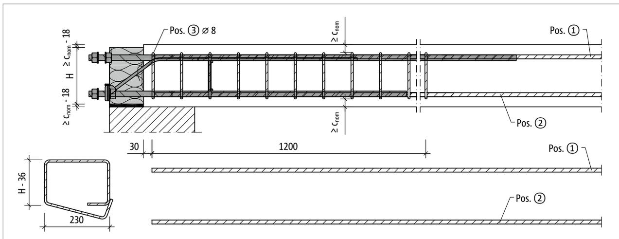
Abb. 56: Schöck Isokorb® XT Typ SK-MM2: Bauseitige Bewehrung mit Bügel  $\varnothing 8$  mm; Schnitt
