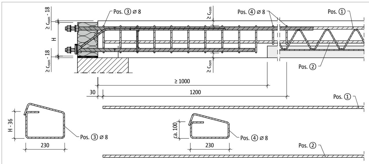
Abb. 63: Schöck Isokorb® XT Typ SK-MM2: Bauseitige Bewehrung bei Fertigteilbauweise mit Bügel  $\varnothing 8$  mm; Schnitt
