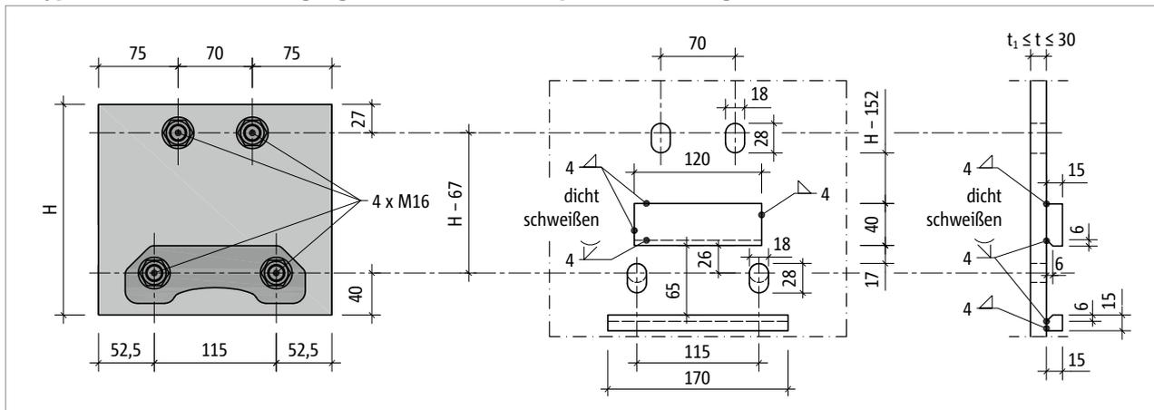
Abb. 66: Schöck Isokorb® XT Typ SK-MM1-VV1: Konstruktion des Stirnplattenanschlusses; Rundlöcher unten, alternativ Langlöcher und eine zweite Knagge zur Übertragung der negativen Querkraft
