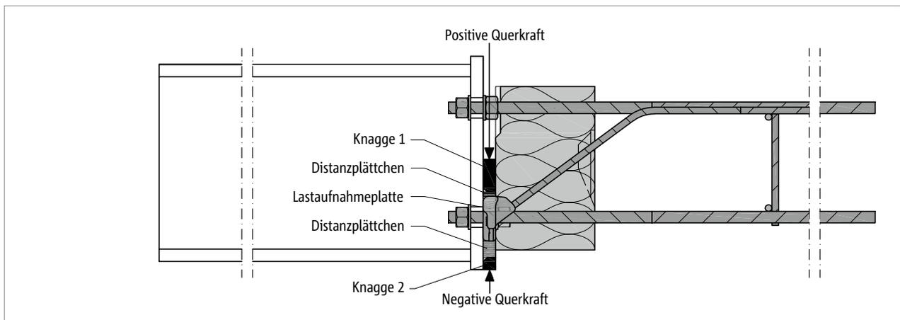
Abb. 73: Schöck Isokorb® XT Typ SK: Bauseitige Knaggen zur Übertragung der Querkraft
