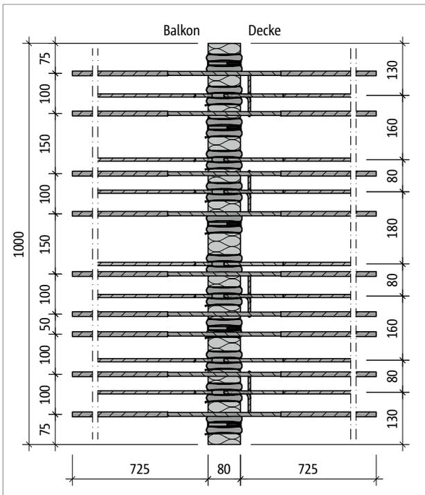
Abb. 60: Schöck Isokorb® T Typ K-M8-V1: Produktgrundriss
