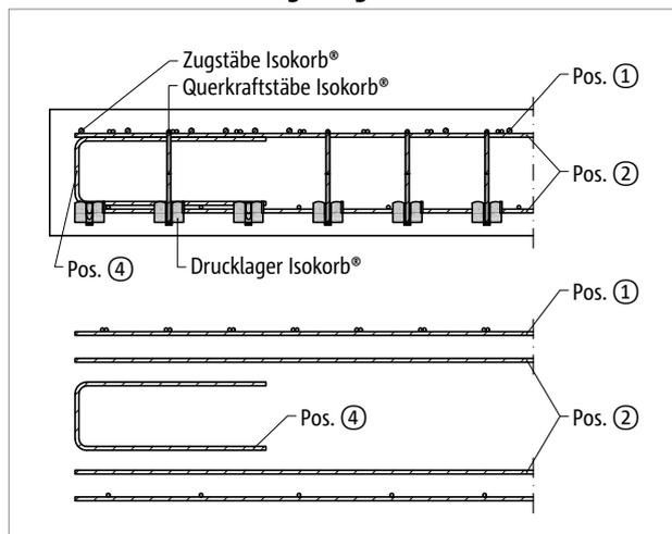
Abb. 73: Schöck Isokorb® T Typ K-M1 bis M11: Bauseitige Bewehrung balkonseitig im Schnitt A-A; Pos. 4 = konstruktive Randeinfassung am freien Rand senkrecht zum Schöck Isokorb®
