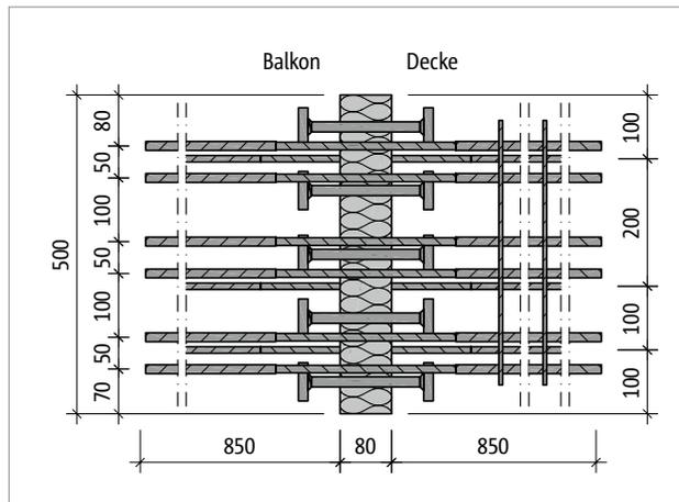
Abb. 64: Schöck Isokorb® T Typ K-M12-V1: Produktgrundriss
