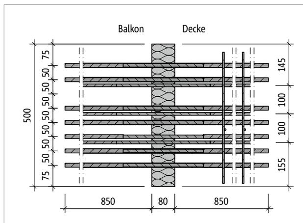
Abb. 66: Schöck Isokorb® T Typ K-M14-V1: Produktgrundriss
