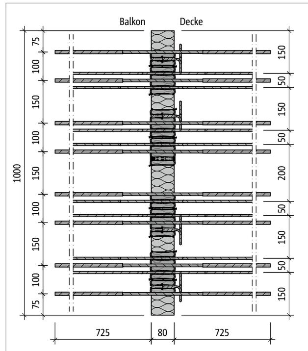
Abb. 61: Schöck Isokorb® T Typ K-M6-VV1: Produktgrundriss
