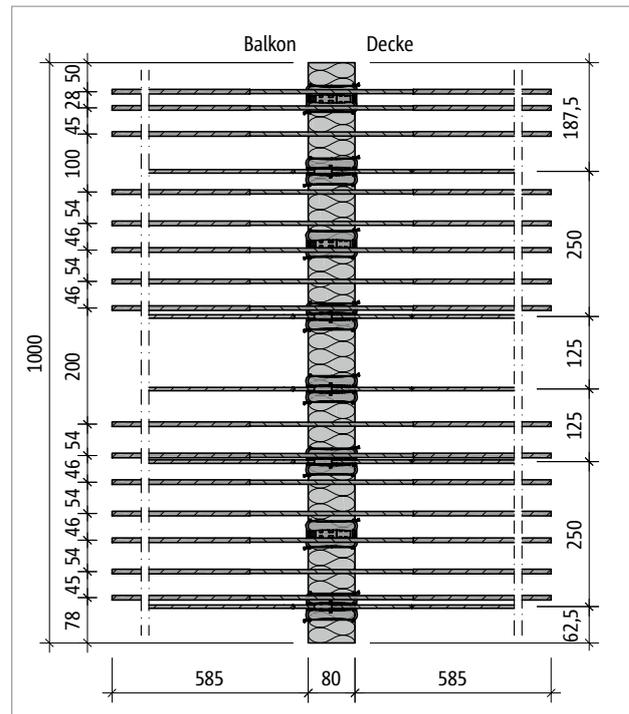
Abb. 57: Schöck Isokorb® T Typ K-M6-V1: Produktgrundriss
