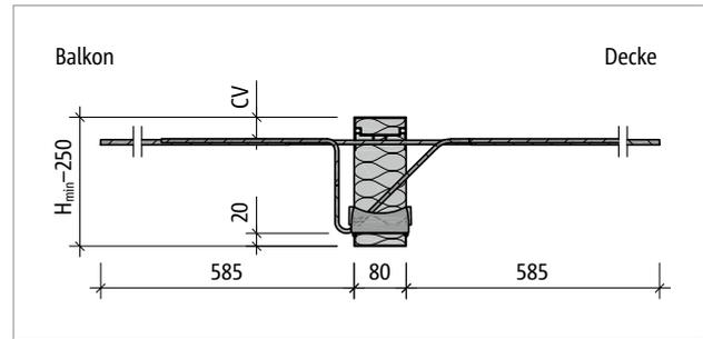
Abb. 68: Schöck Isokorb® T Typ K-M5 und K-M6 bei R0: Produktschnitt
