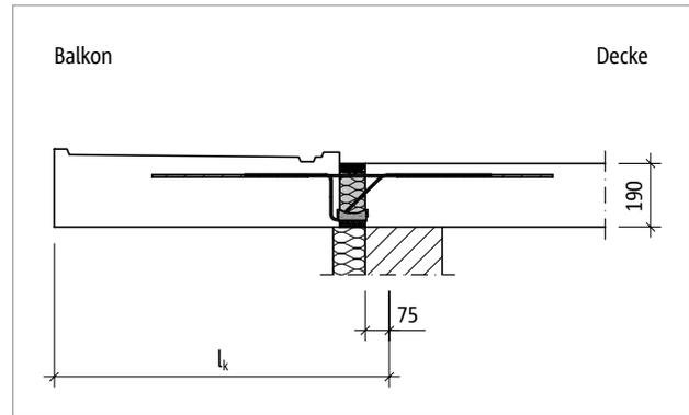
Abb. 86: Schöck Isokorb® T Typ K: Statisches System
