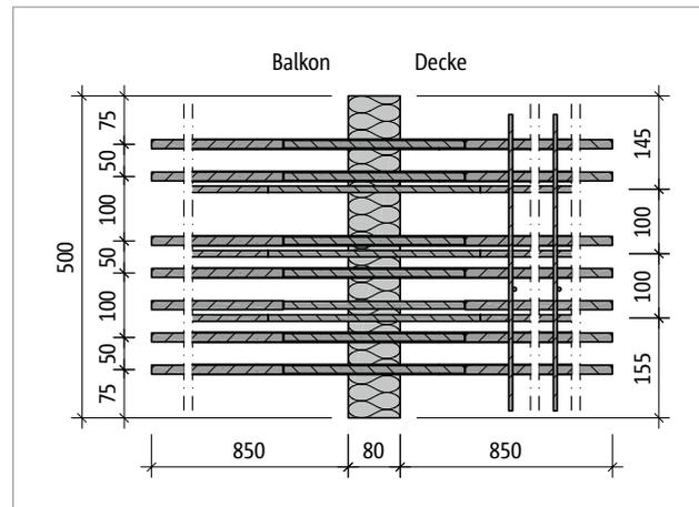
Abb. 65: Schöck Isokorb® T Typ K-M13-V1: Produktgrundriss
