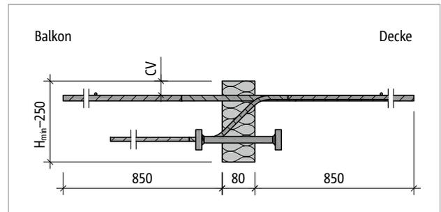
Abb. 70: Schöck Isokorb® T Typ K-M12 bei R0: Produktschnitt
