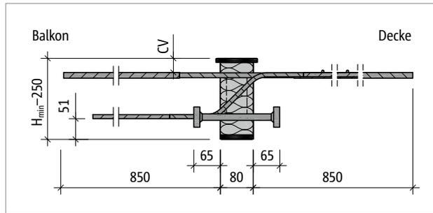
Abb. 62: Schöck Isokorb® T Typ K-M12: Produktschnitt
