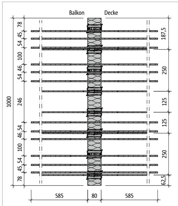
Abb. 56: Schöck Isokorb® T Typ K-M4-V1: Produktgrundriss
