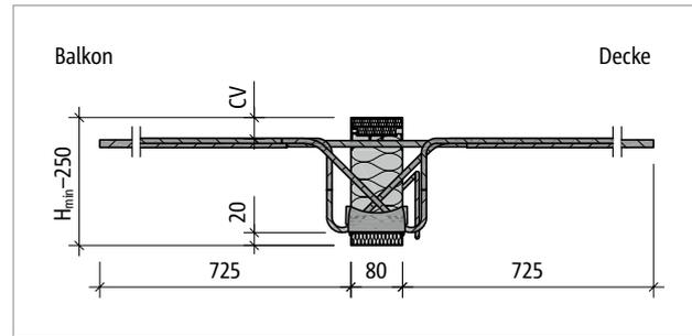
Abb. 59: Schöck Isokorb® T Typ K-M6-VV1: Produktschnitt
