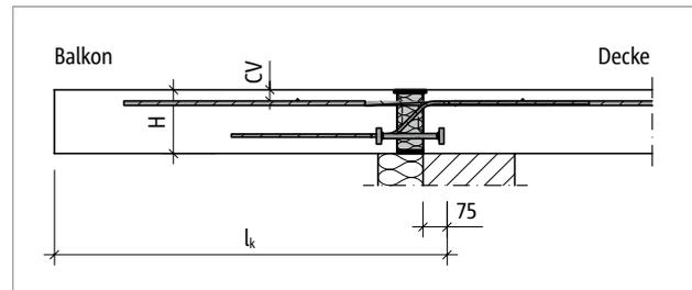
Abb. 52: Schöck Isokorb® T Typ K-M12: Statisches System
