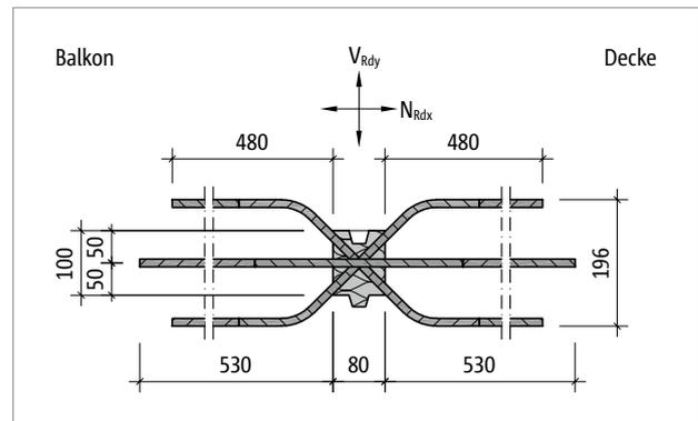
Abb. 291: Schöck Isokorb® T Typ H-VV2-NN1: Produktgrundriss
