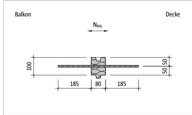
Abb. 285: Schöck Isokorb® T Typ H-NN1: Produktgrundriss
