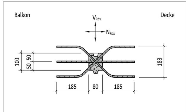
Abb. 289: Schöck Isokorb® T Typ H-VV1-NN1: Produktgrundriss
