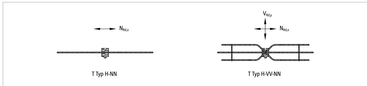
Abb. 279: Schöck Isokorb® T Typ H: Typenauswahl
