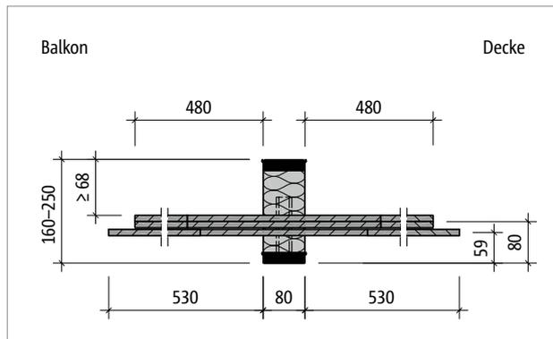
Abb. 290: Schöck Isokorb® T Typ H-VV2-NN1: Produktschnitt
