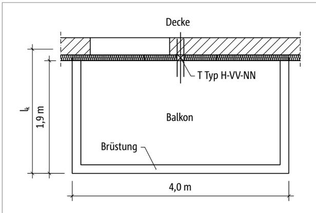
Abb. 293: Schöck Isokorb® T Typ K, H: Grundriss
