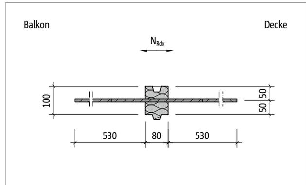
Abb. 287: Schöck Isokorb® T Typ H-NN2: Produktgrundriss
