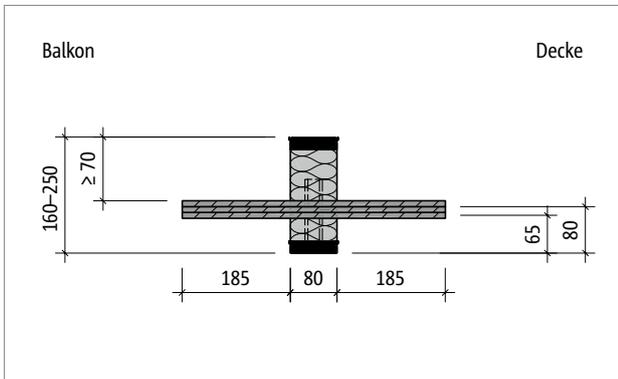
Abb. 288: Schöck Isokorb® T Typ H-VV1-NN1: Produktschnitt
