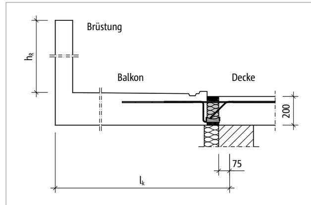
Abb. 294: Schöck Isokorb® T Typ K: Statisches System
