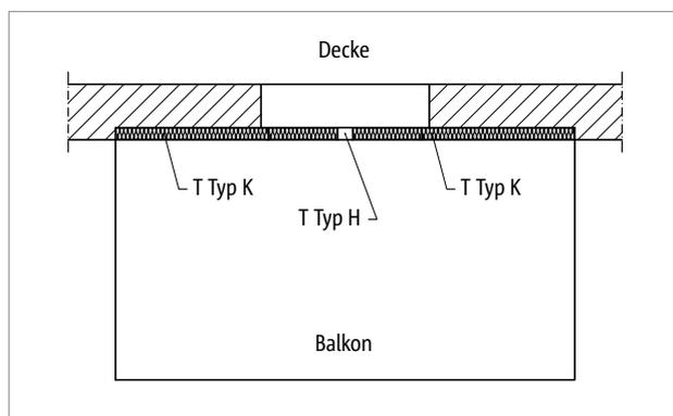
Abb. 275: Schöck Isokorb® T Typ H: Balkon frei auskragend
