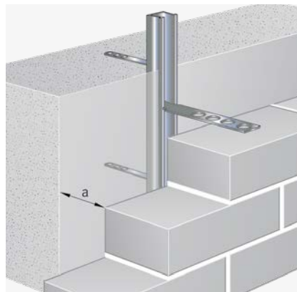
Anschluss von Verblendschalen an Stahlbetonbauteile mit Maueranschlussschiene Kt 28/15-D und -anker
