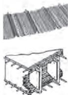
Siegrastahl-Streckmetall als verlorene Schalung für Aufkantung, Abstellung für Bodenplatten, Decken und Aussparungskörper.
