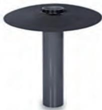
Dickwandiges Kunststoff-Futterrohr Echtmaß für den nachträglichen Einbau von Rohren und Kabeln, mit einseitig angeformtem KRASO® Folienflansch, öl- und bitumenbeständig, umlaufend ca. 15 cm.
