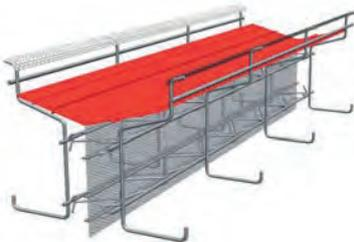
Bodenteil aufstellen und sichern, Fugenband einlegen.
