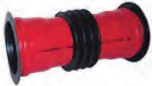
In Übereinstimmung mit DIN EN 14758, für den Einbau in WU-Betonwände zum beidseitigen Anschließen von KG/HT - Rohren, mit druckwasserdichter, umlaufender, thermisch verschweißter KRASO® Vierstegdichtung, beidseitig angeformter Steckmuffe und 2 KRASO® Deckeln als Einbauhilfe
