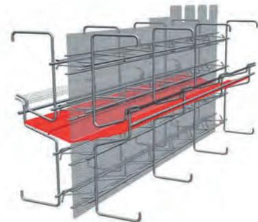
Oberteil und Unterteil mit Bindedraht verrödeln.
