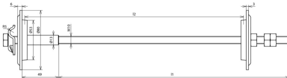
Mit MV-Klemme aus NIRO (V4A) für Rundleiter 8-10 mm.
