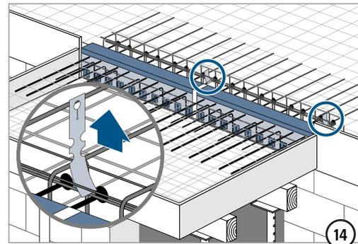
Vor Betonage alle roten Warnhinweise entfernen!
