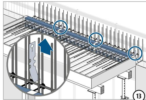
Vor Betonage alle roten Warnhinweise entfernen!
