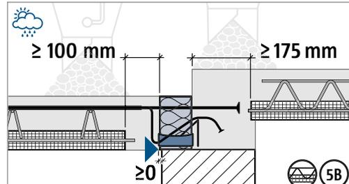
Druckfuge unbedingt mit Ortbeton verfüllen! Fugenbreite ≥ 100 mm. Mindest-Unterzugdicke ≥ t.
