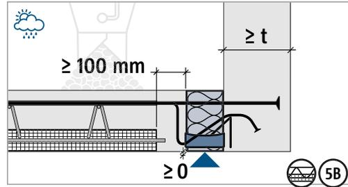
Druckfuge unbedingt mit Ortbeton verfüllen!
