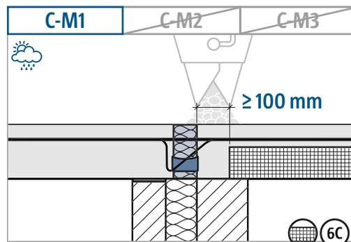
6A-6C Druckfuge unbedingt mit Ortbeton verfüllen! Fugenbreite ≥ 100 mm.
