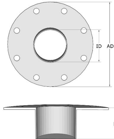
• ID | Rohrhülse Innendurchmesser (mm) • AD | Außendurchmesser Flanschplatte (mm) • L | Vorbaulänge (mm)
