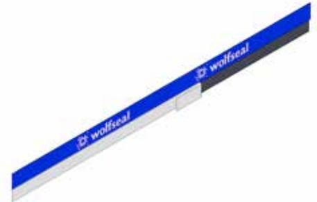
Bei einer Einbindetiefe von 3 cm ist **wolfseal** KB 16 bis 5,0 bar geprüft (zulässig nach AbP 2,0 bar, dies entspricht einer 2,5-fachen Sicherheit auf den Prüfdruck.)
