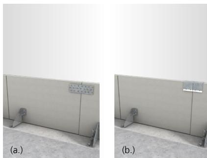
Je nach Länge des bauseits zugeschnitten Elements kann das Element mit Hilfe der optionalen Befestigungsglasche (a.) oder dem Attika Fix Ausrichtungsprofil (b.) mit dem bestehenden Element verschraubt werden.
