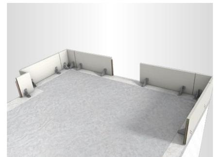
Anschließend werden die Attika Fix Elemente mittels lose beigelegter Steckfeder mit der Attika Fix Ecke verbunden und danach in der Betondecke verschraubt.
