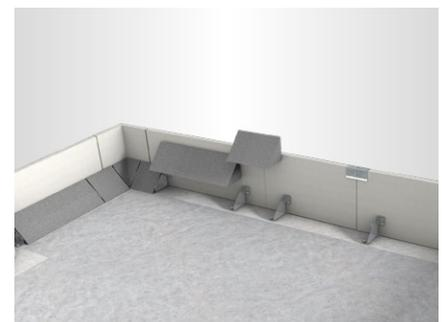
Die optionalen rekord Dämmkeile werden nach der Montage der Attika Fix vor Ort angepasst, zwischen die Winkel eingesetzt und verklebt. Dadurch erleichtern sie das Aufbringen der Absperrbahn.
