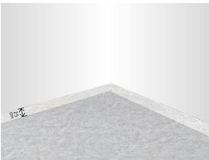
Die Betondecke wird im äußeren Bereich min. 25 cm breit plan abgezogen.
