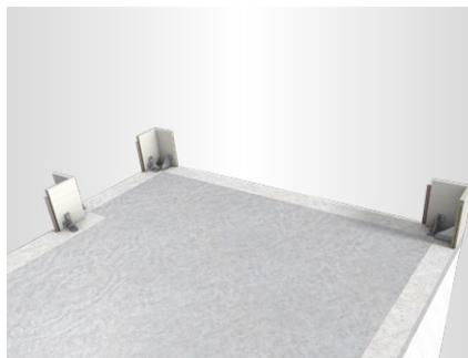
Zunächst werden die Attika Fix Eckelemente aufgestellt und mit z.B. 10 x 90 mm Schrauben in der Betondecke befestigt.
